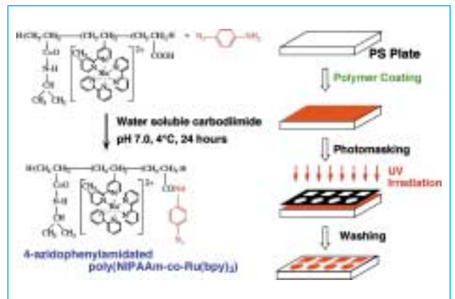
図1. 光リソグラフィーによるゲルの微細加工
