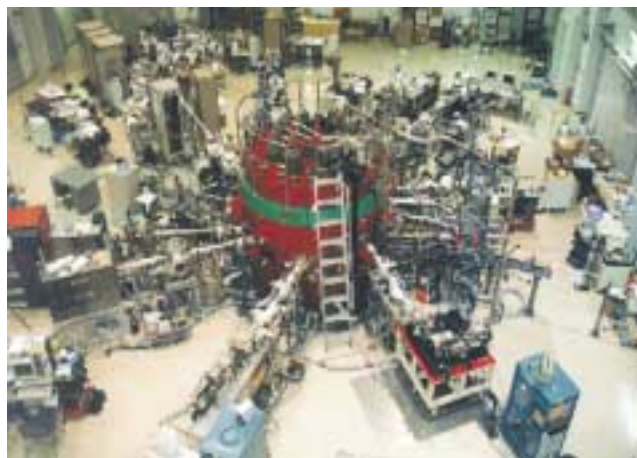
立命館大学所存のシンクロトロン(波長1.5 nmにピークを持つ)
