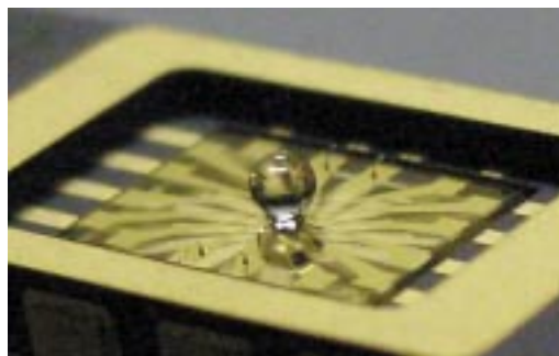
図2 球状SAWガスセンサ
