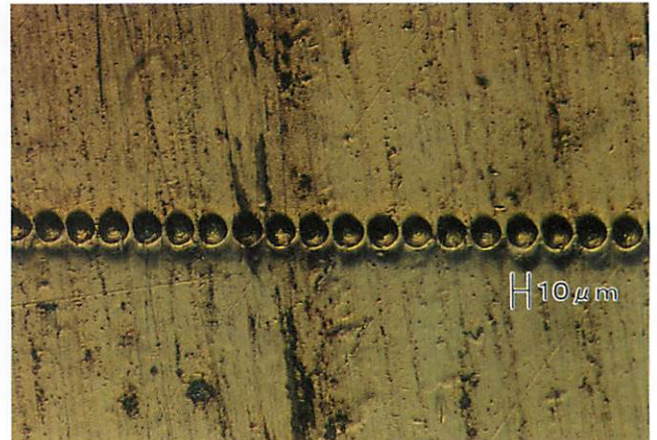
図4. 試料面に連続点描された加工痕 (Dynamic Indentation)
