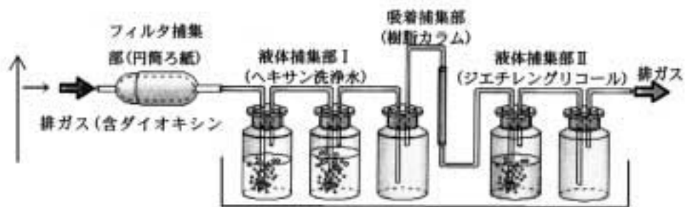
既存化学機器による、排ガス中からのダイオキシン捕集装置の例
