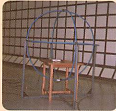
ラージループアンテナを使用した放射磁界の測定
