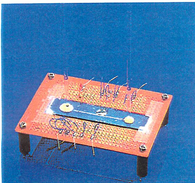
図1 陽極接合で製作したマイクロポンプ (機械技術研究所、カナダサイモンフレーザ大学)
